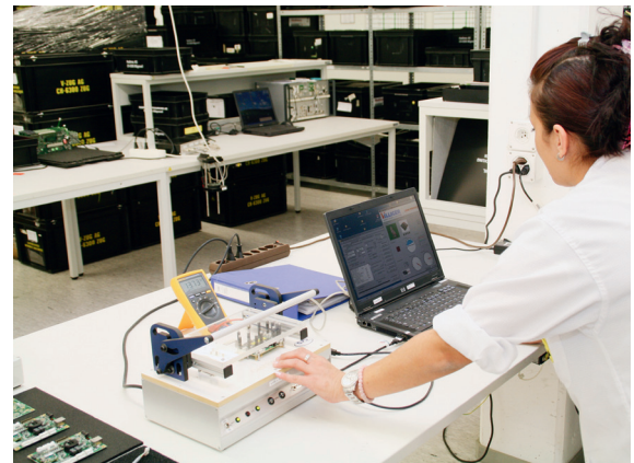
Hadimec prüft alle Villiger-Boards auf selbst entwickelten In-Circuit- und Funktionstestern zu 100 Prozent
