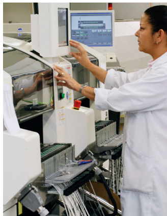
Top-Produktion dank modernen SMT-Bestückungsautomaten
